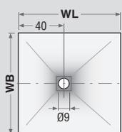
Pour les dimensions 90 x 90 et 100 x 100 l'écoulement n'est pas centré.
