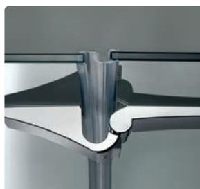
*Lors de l'ouverture le bout de la porte bascule dans la cavité arrondie de la charnière, stoppé en douceur par le joint du deuxième élément en verre. Quand la porte est fermée, les deux joints d'étanchéités s'imbriquent et empêchent efficacement l'eau de sortir.*
